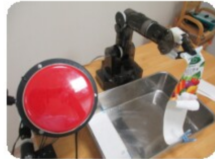
ロボットアームを使ったビニールをはがし
